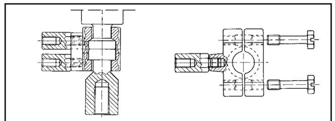
**Fig. 3: NAMUR coupling half**
