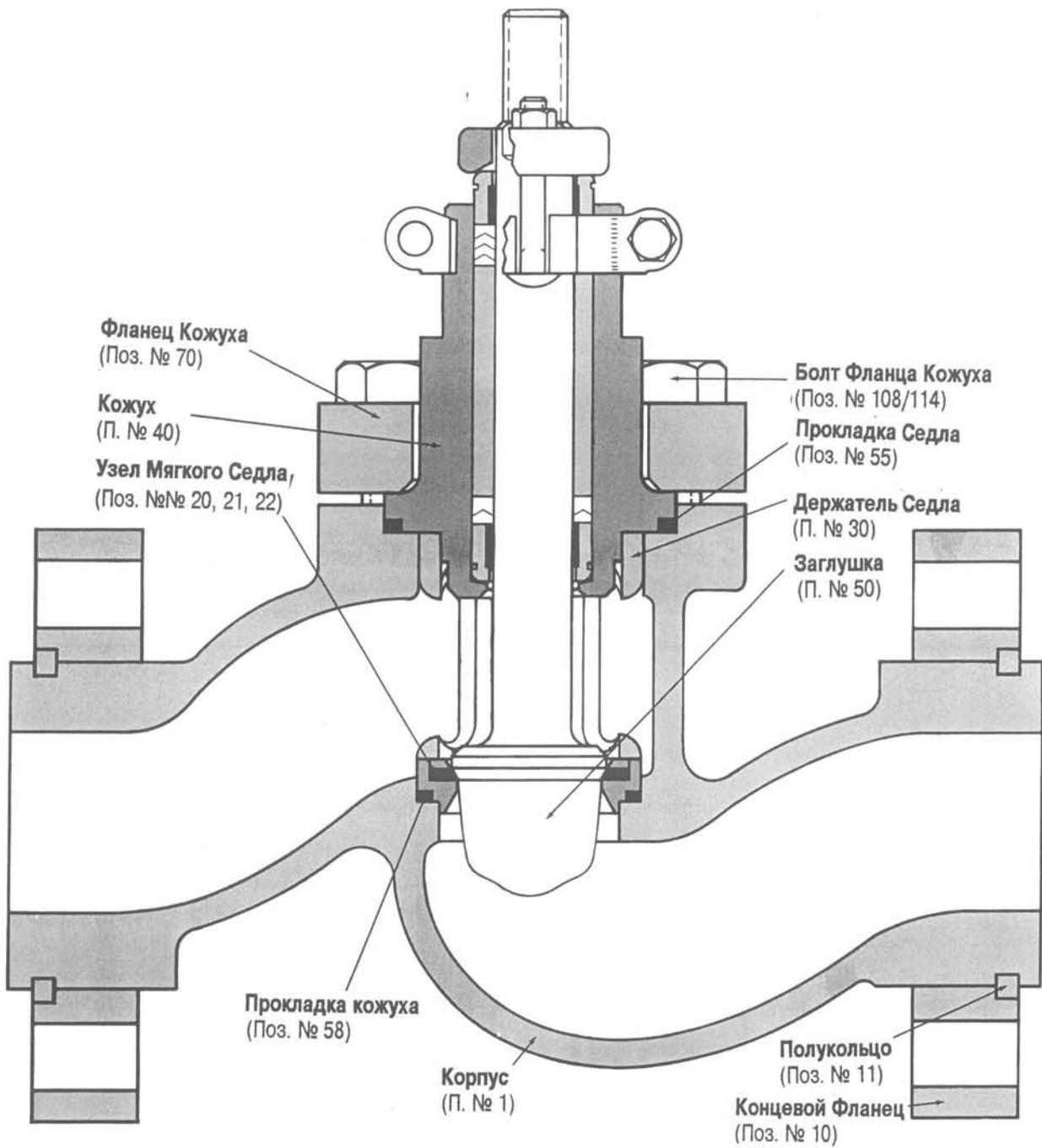
**Рис. 2: Шаровой Клапан Марк Один с Мягким Седлом**
