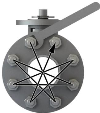
6. Montieren Sie den ARGUS-Mehrwegkugelhahn an die weiteren Flansche:
