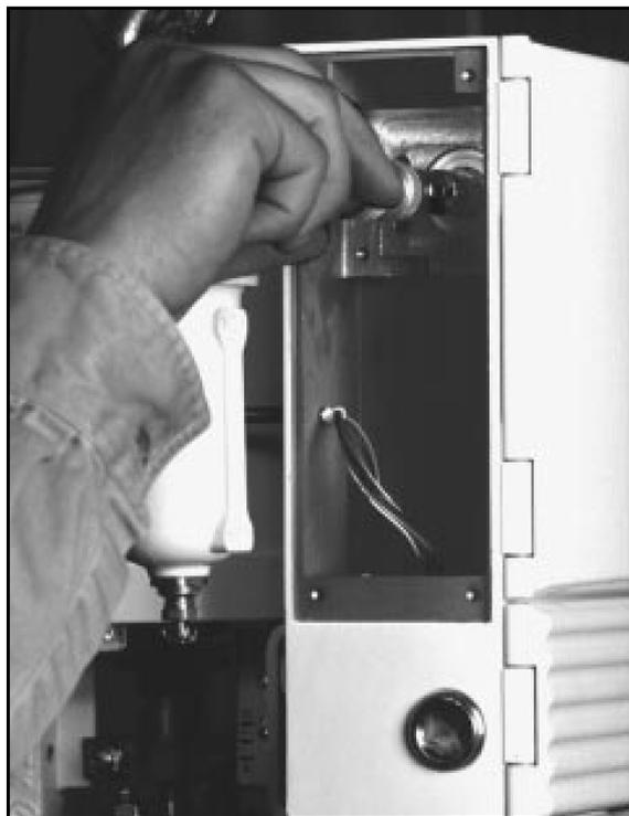
**Fig. 12 : Montage du guide du clapet**
