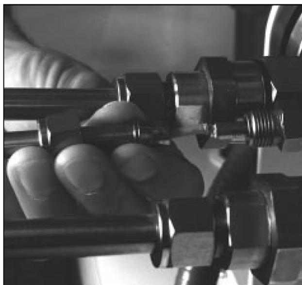
**Fig. 8 : Remplacement du thermocouple**
