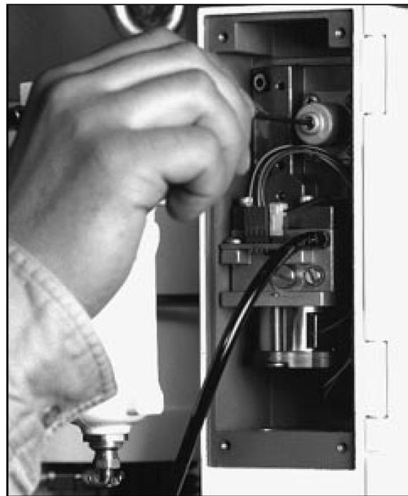
**Fig. 11 : Réglage de la pression du régulateur**
