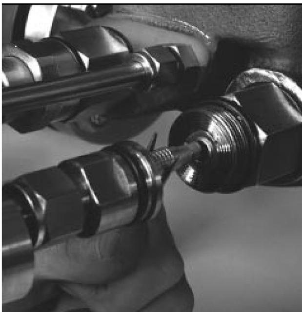
**Fig. 7 : Dépose du connecteur Lemo**
