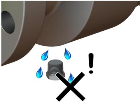
4. Schrauben Sie die Ablassschraube wieder an die Unterseite des ARGUS-Kugelhahn-Gehäuses.
