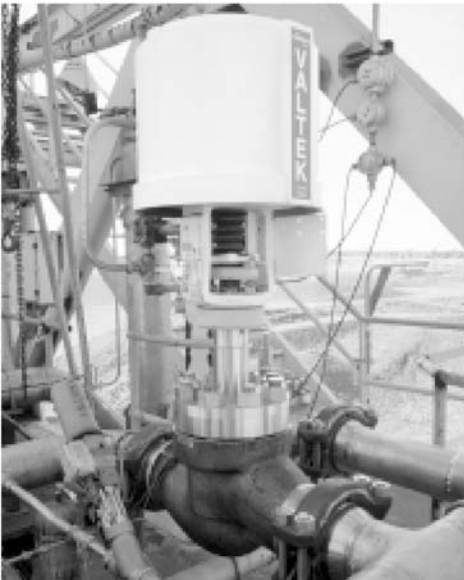
Mark One-Tieftemperaturventil als O 2 -Belüftungsventil in einem luftfahrttechnischen Prüfsystem .
