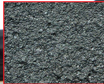
Flowserve feinkörnig UNCD beschichtete Gleitfläche unter tausendfacher Vergrößerung
