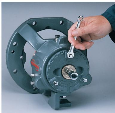
**Étape 1 :** Desserrez les vis d'arrêt. Avec une clé, tournez le porte-palier dans le sens anti horaire jusqu'à ce que la roue touche légèrement la plaque de recouvrement arrière.
