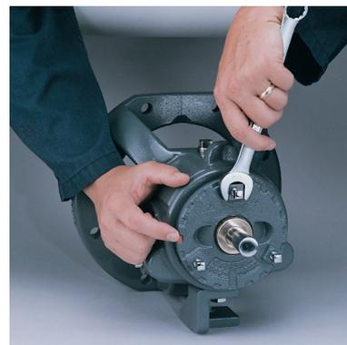
**Étape 3 :** Déplacez le porte palier dans le sens horaire selon le nombre d'encoches choisi. Serrez les vis d'arrêt et vérifiez le jeu de la roue avec la jauge d'épaisseur.
