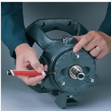
**Étape 2 :** Choisissez le jeu d'impulseur approprié. Chaque encoche de la bague du porte-palier correspond à exactement à un jeu de 0.10 mm (0.004 in.). Si le jeu de la roue doit être de 0.5 mm (0.020 in.), comptez 5 encoches dans le sens anti horaire.
