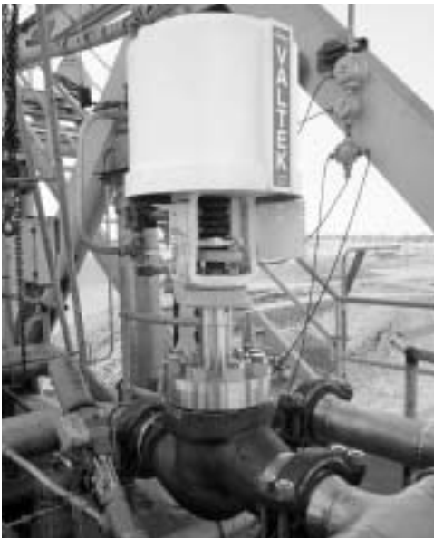
Mark One cryogéniques utilisées comme vannes de purge LO 2 pour des tests aérospatiaux .
