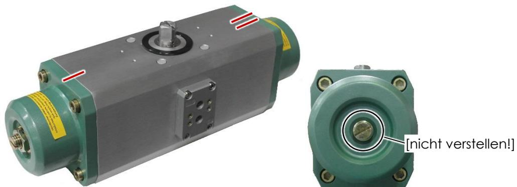
2. Markieren Sie die Lage der Antriebswellennut am Gehäuse [10].
