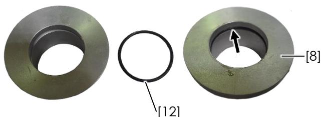
**25.** Poser la douille de compensation [8] dans l'alésage de palier.
