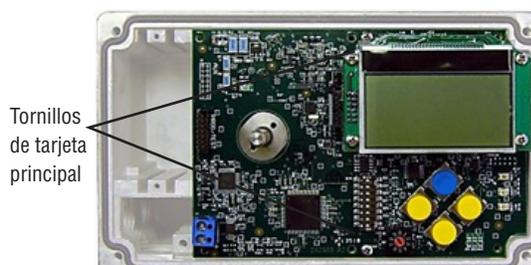
Figura 51: Tornillos de tarjeta principal
