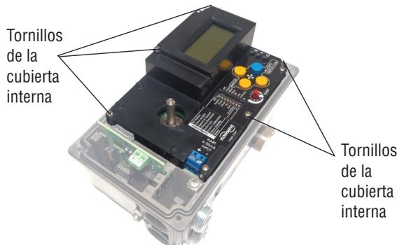
Figura 48: Cubierta interna
